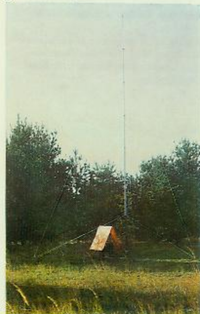
10 m-Stabantenne mit Antennenanpaßgerät KTA 1300
